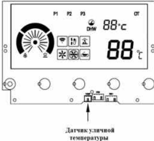
После подключения датчика уличной температуры необходимо активировать работу котла в погодозависимом режиме (см. раздел 7.4., параметр db, параметр Ot).
