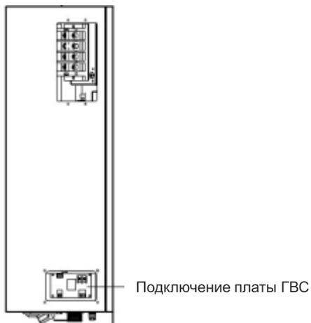
Схема подключения платы ГВС см. п. 9.2.5.
