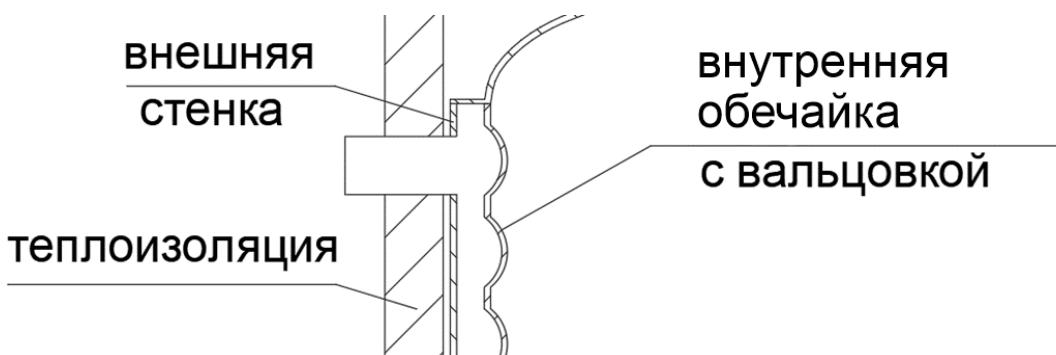
2.1. Бойлер FED INOX сконструирован по схеме: внутренний бак бойлера (контур горячего водяного снабжения (далее ГВС) с водяной рубашкой (контур обогрева бойлера через систему отопления (далее СО). Для повышения производительности внутри водяной рубашки предусмотрены направляющие потока воды. Для увеличения прочности, внутренние стенки имеют вальцовку. Дно бойлера так же двойное, что увеличивает производительность бойлера и устраняет зону непрогретой воды внизу бака.
