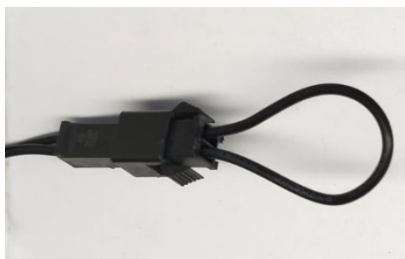
Рис.9 Штекер с перемычкой комнатного термостата
