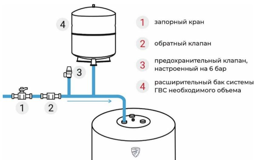
Подключите трубопровод для горячей воды 3/4" к патрубку, имеющему маркировку ГОРЯЧАЯ.
